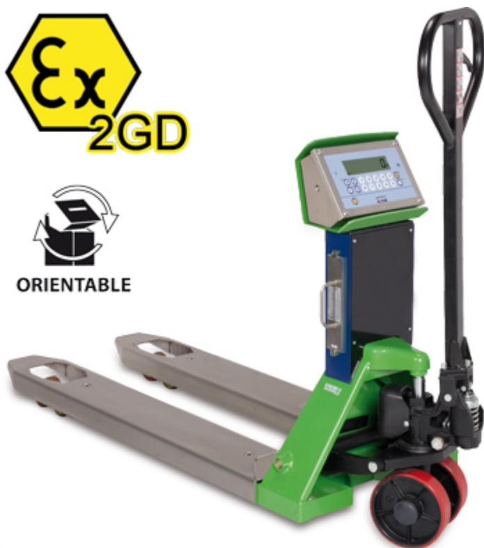
Transpallet con pesatura elettronica integrata per aree pericolose, classificate a rischio di esplosione (ZONE 1 e 21 & 2 e 22) con modo di protezione secondo Ex II 2GD IIB T4 T197°C X. Il rilevamento del peso a 4 celle di carico inox IP68, certificate ATEX, garantisce la massima precisione in ogni condizione di lavoro. Disponibili anche in versione OMOLOGATA CE-M.
