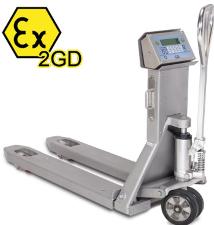
Transpallet con pesatura elettronica integrata per aree pericolose, classificate a rischio di esplosione (ZONE 1 e 21 & 2 e 22) con modo di protezione secondo Ex II 2GD IIB T4 T197°C X. Il rilevamento del peso a 4 celle di carico inox IP68, certificate ATEX, garantisce la massima precisione in ogni condizione di lavoro. Struttura completamente in acciaio INOX. Disponibili anche in versione OMOLOGATA CE-M.
