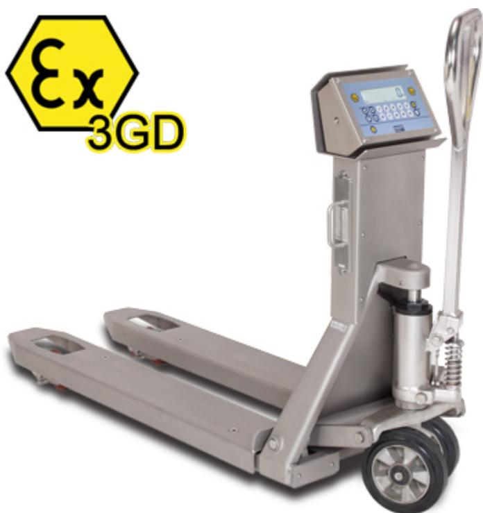
Transpallet con pesatura elettronica integrata, adatti per aree pericolose classificate a rischio di esplosione (ZONA ATEX 2 e 22) con modo di protezione secondo Ex II 3GD IIC T6 T130°C X. Il rilevamento del peso a 4 celle di carico inox IP68, certificate ATEX, garantisce precisione in ogni condizione di lavoro. Struttura completamente in acciaio INOX. Disponibili anche in versione omologata CE-M.
