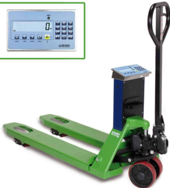
Transpallet con pesatura elettronica integrata, semplici, affidabili, adatti per condizioni gravose di lavoro. Sono indispensabili dove occorre pesare con precisione risparmiando tempo. Batteria ricaricabile estraibile di serie. Disponibile anche con stampante integrata e in versione omologata CE-M DOPPIA SCALA.
